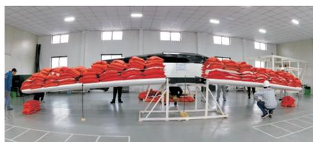
图 8 机翼限制载荷试验
