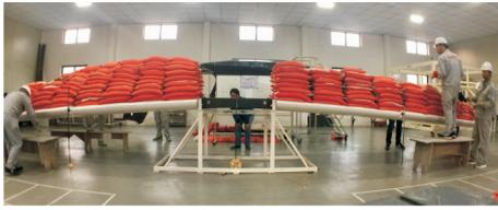
图 9 M2 飞机机翼极限载荷试验
