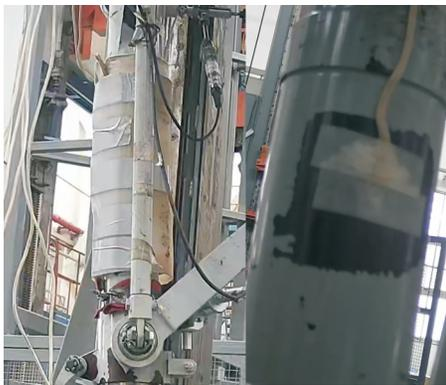
图 3 温度监控及缓冲器加热照片
