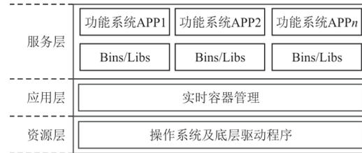
图6 容器软件架构示意图
